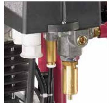
Sicherheitsventil und Druckentlastungsventil
