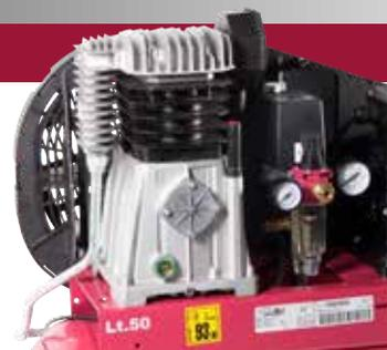
Technische Ästhetik im Detail: Gusszylinder mit Nachkühlung
