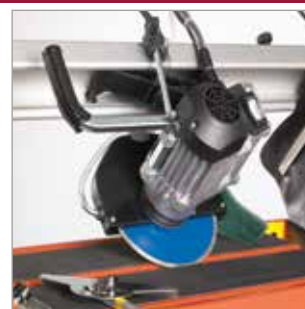
Starker Antriebsmotor und Parallelführung
