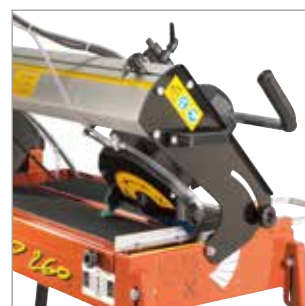
Einfache, präzise Einstellung von 0 - 45°
