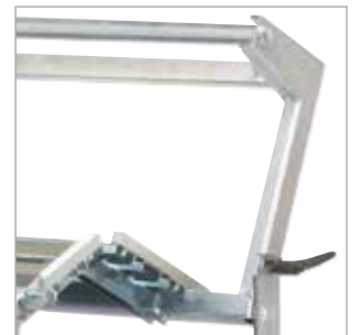
Spannhebel für Gehrungsschnitte 0 - 45°
