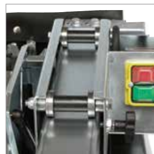
Leichtgängiger Rollschlitten auf Präzisionslagern
