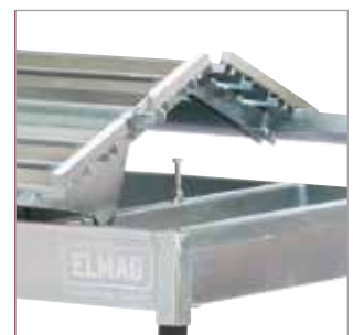
Spannhebel für Gehrungsschnitte 0 - 45°
