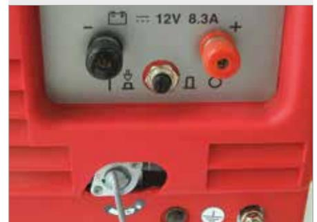
**Akkulader und Überlastsicherung**
