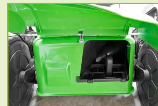
Mulchfunktion mulching function
