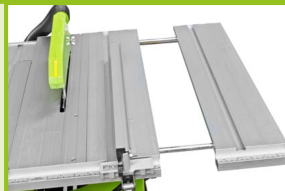
mit Tischverbreiterung with sliding table
