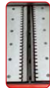
mechanisches Zählwerk beim Dickenhobeln (Genauigkeit 0,1 mm) mechanical counter for thicknessing (accuracy 0,1 mm)
