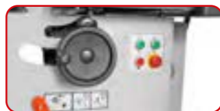
leichtgängige und präzise Sägeblatt Höhen- und Winkelverstellung mittels Handrad smooth-running and precise saw blade height and angle adjustment by means of handwheel
