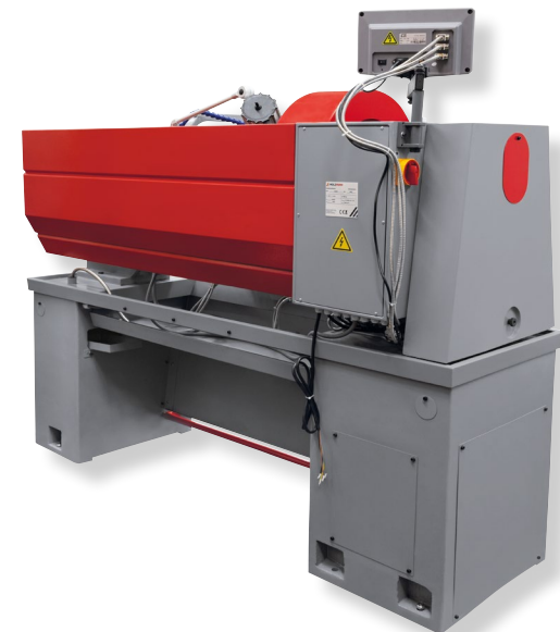
elektromagnetische Fußbremse - für maximale Sicherheit und minimale Nebenzeiten durch sofortigen Spindelstopp electromagnetic foot brake ensures maximal working safety and cuts down nonproductive time dramatically
